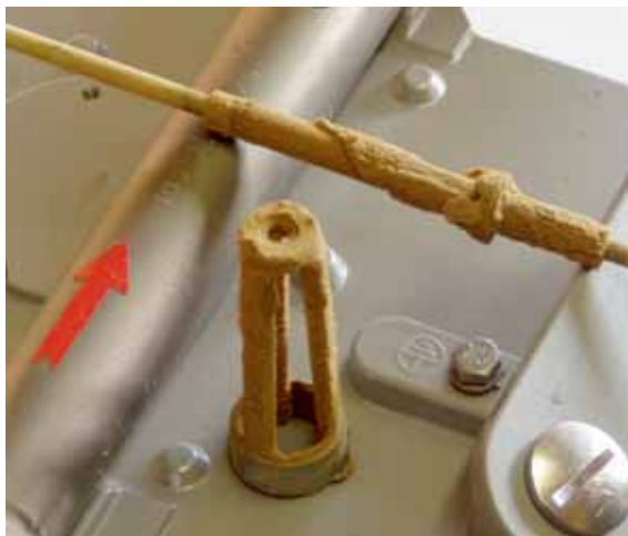
Bild 19: Ablagerungen auf SNCR-Anlagenteilen durch Kalkausfällungen
