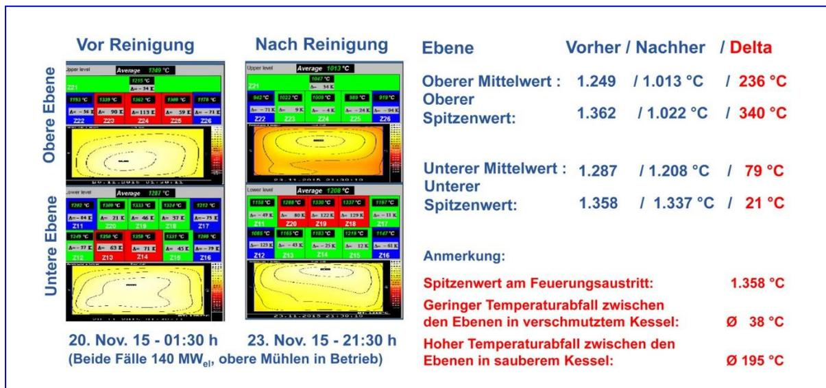
Abb. 6: Auswirkung der Reinigung auf die Rauchgastemperaturen (140 MW<sub>el</sub>)
