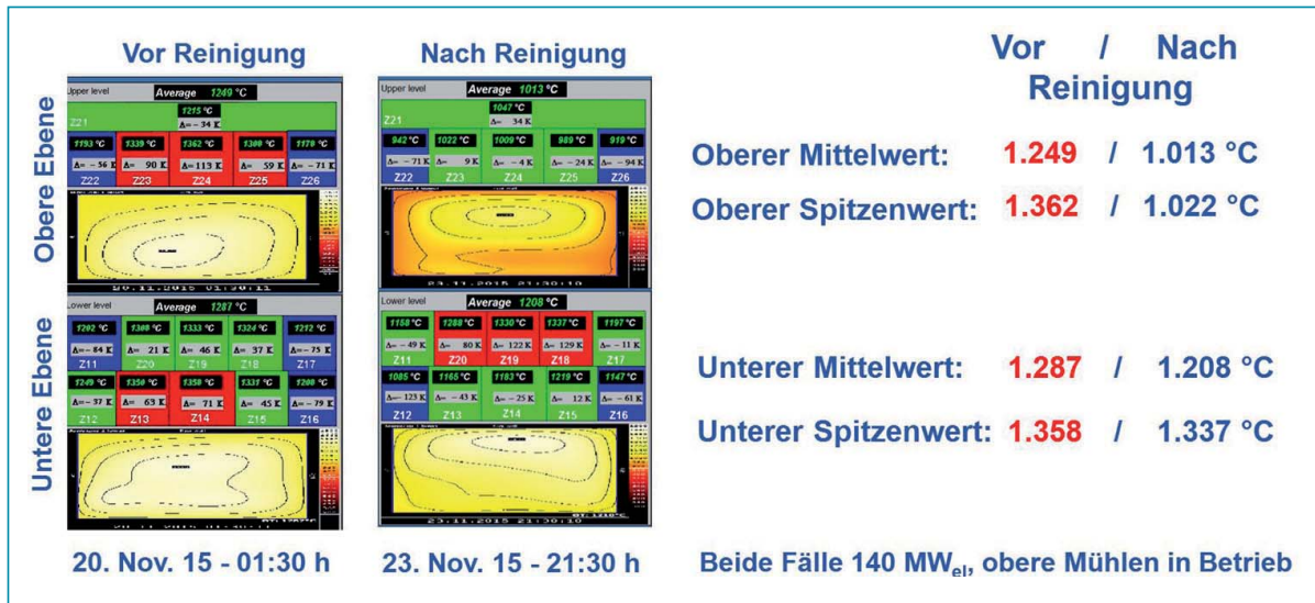
Abb. 3: Auswirkung der Kesselreinigung auf die Rauchgastemperaturen
