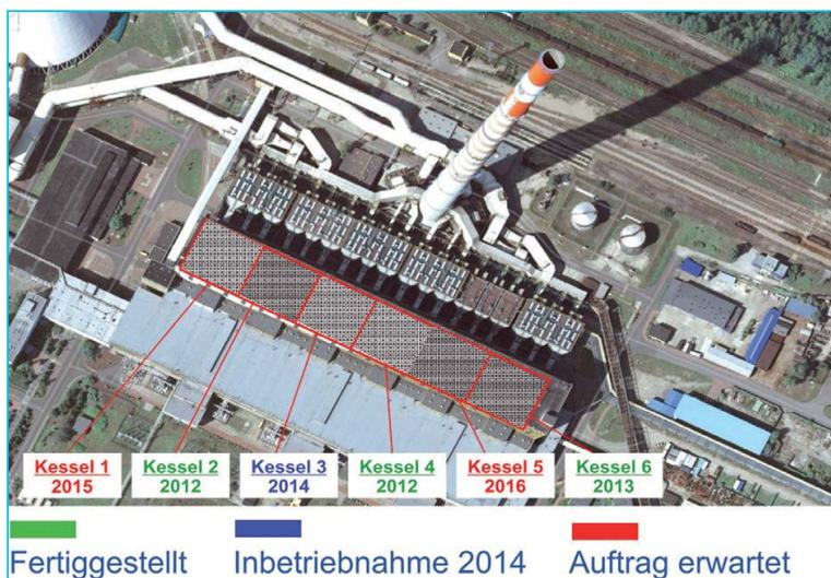
Abb. 15: Jaworzno III, Polen – Zeitlicher Ablauf der SNCR Inbetriebnahmen
